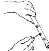
USE UN PICADIENTES (PALILLO) PARA ABRIR LOS ORIFICIOS. DESTAPAR POR LAS PUNTAS, REMOVIENDO EL TAPON Y ENGUAGAR LOS CON AGUA.
